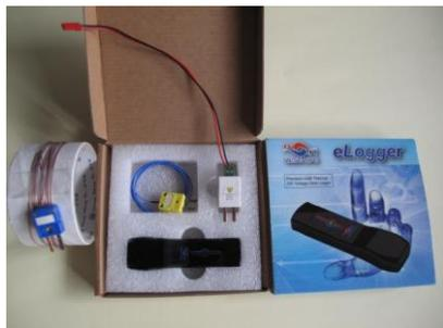
溫度量測儀器、電壓記錄器
