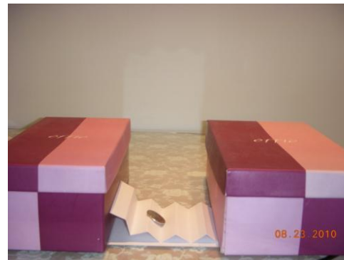
【圖十四】摺向與兩岸平行的西卡紙承受硬幣實驗
