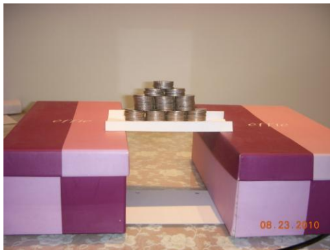
【圖十三】摺向與兩岸垂直的西卡紙承受硬幣實驗
