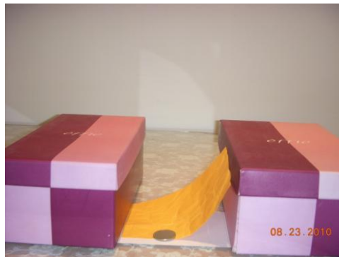
【圖三】牛皮紙承受硬幣實驗
