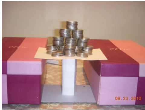
【圖十八】固定一個紙橋墩可承受幾枚硬幣的實驗
