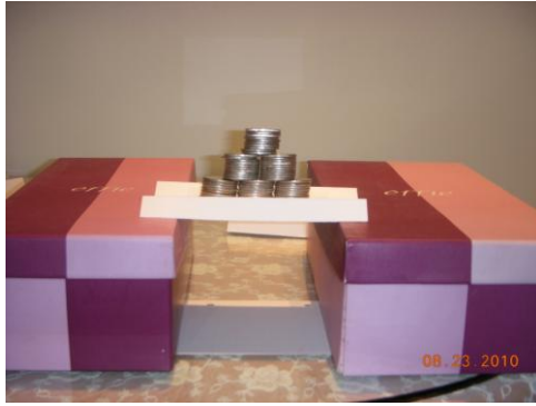
【圖十一】三條摺數 (W) 的西卡紙承受硬幣實驗
