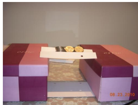
【圖十】雙條摺數 (^^) 的西卡紙承受硬幣實驗
