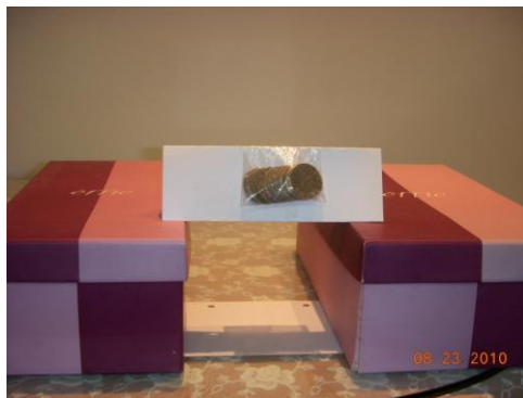
【圖九】單條摺數 (A) 的西卡紙承受硬幣實驗
