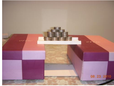
【圖十二】四條摺數 (M) 的西卡紙承受硬幣實驗
