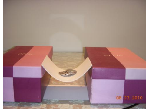
【圖五】1 張大西卡紙承受硬幣實驗 【圖六】2 張大西卡紙承受硬幣實驗
