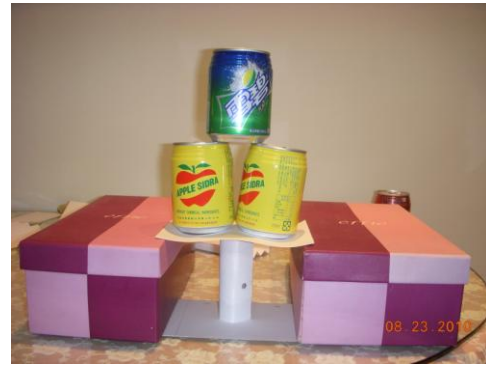
【圖十九】固定一個紙橋墩可承受幾瓶小罐裝飲料的實驗
