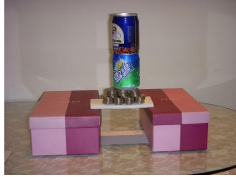
【圖十七】摺向與兩岸平行並在上、下各黏一張紙的紙橋承受硬幣實驗之二
