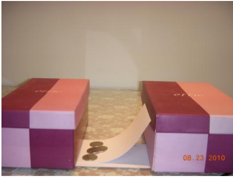
【圖五】1 張大西卡紙承受硬幣實驗 【圖六】2 張大西卡紙承受硬幣實驗
