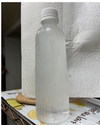
[圖十七、過冷後結冰情形]
