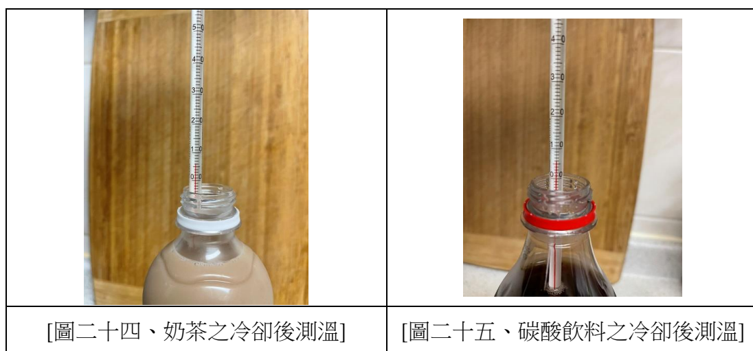
【表十一、實驗四結果：不同溶液測量其過冷溫度，並確認樣品是否瞬間結冰】
