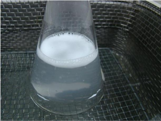
圖十六 將已經將洗衣粉倒入三角錐瓶裡的三角錐瓶放到超音波震盪加快溶解速度。
