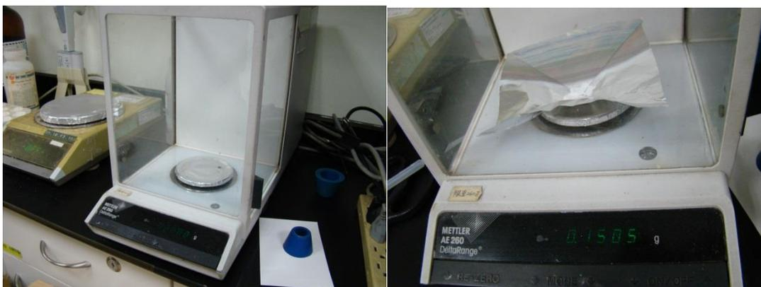
圖四~圖五、為秤量 150 毫克洗衣劑的情
