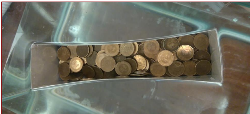
圖七 船身無法承受水的側向壓力而變形
