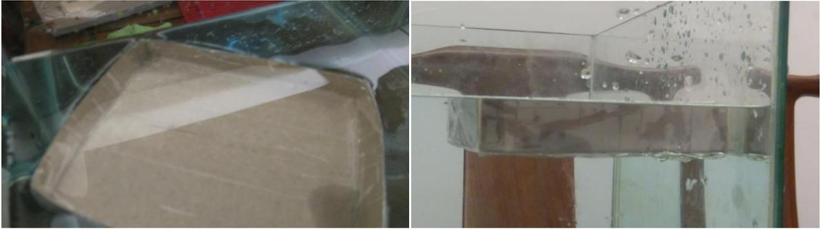
四、從實驗一的數據結果我們發現，船底面積與船身高度的比值越大可以載的硬幣數量、硬幣重量、船所受的浮力等都越大，而且很多船所載的重量都大於它的設計體積  $200\text{cm}^3$  所可以排開的水重量 200 公克，根據我們的觀察認為應該是船身周圍的水因為表面張力的關係不會馬上淹進船裡，所以造成船所載的硬幣重量大於 200 公克，如圖十五。
