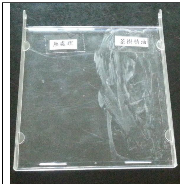
壓克力板明顯被茶樹精油腐蝕了， 變得白白的
