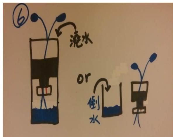
二、利用毛細現象自動給水，並比較不同粗細的棉線、放置棉線方法、給水區放置不同高度的給水量，測試看看是否可以自動調控水量，嘗試找出適合家中盆栽運用的方法。
