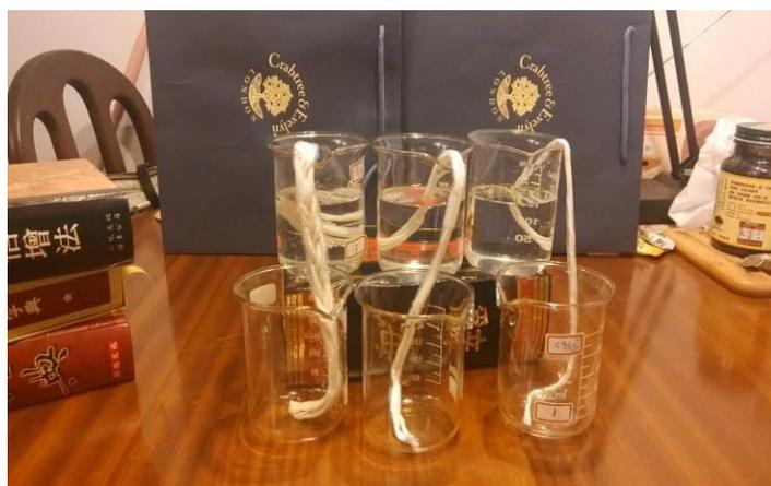
實驗(三)延續實驗(二)的方法，比較給水區放在不同位置：給水區和受水區等高、給水區低於受水區 45 度、給水區低於受水區 90 度垂直時，給水情形有何不同。
