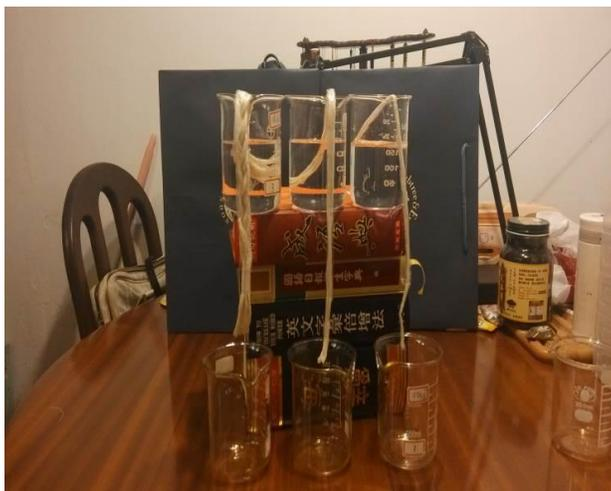
實驗(二) 測量棉線一端浸在給水區(容器中裝水)，另一端棉線頭放入受水容器中的底部(水過來時棉線頭會完全浸在水中)，當受水區那一端的棉線也浸在水中時，會不會減緩或暫停給水？以達到自動調控給水量的目的。
